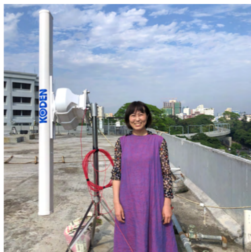
バングラデシュに設置した船舶レーダー。通常の気象レーダーが1台数千万とくらべて、数百万。通常は横回転で使用するが、縦に回転させることで、雨雲の断面の計測が可能。
